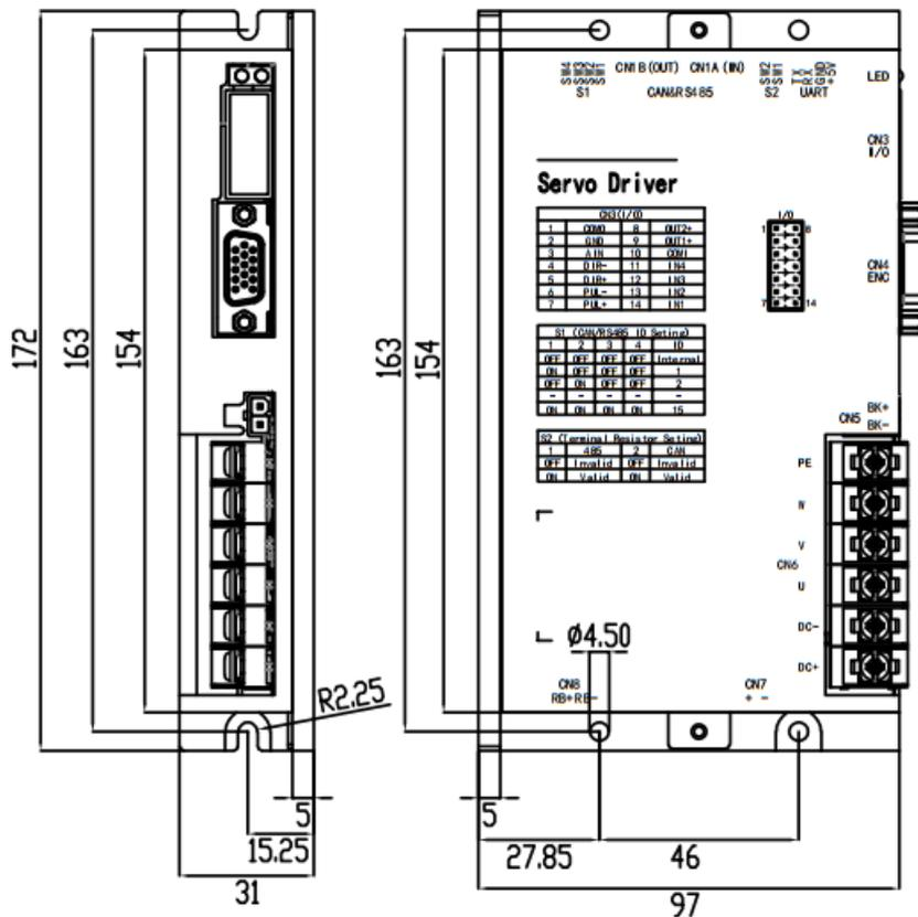
图 3-2 SVD4822RC-AA 驱动器安装尺寸
