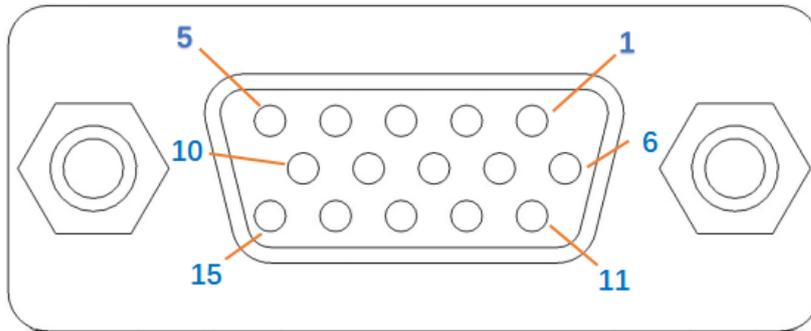
图 4-3 编码器电机的引脚定义
