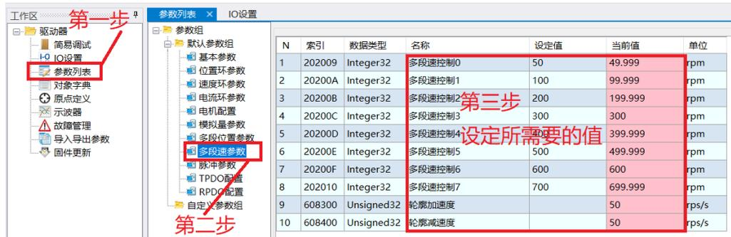
图 6-2 多段速参数设置
