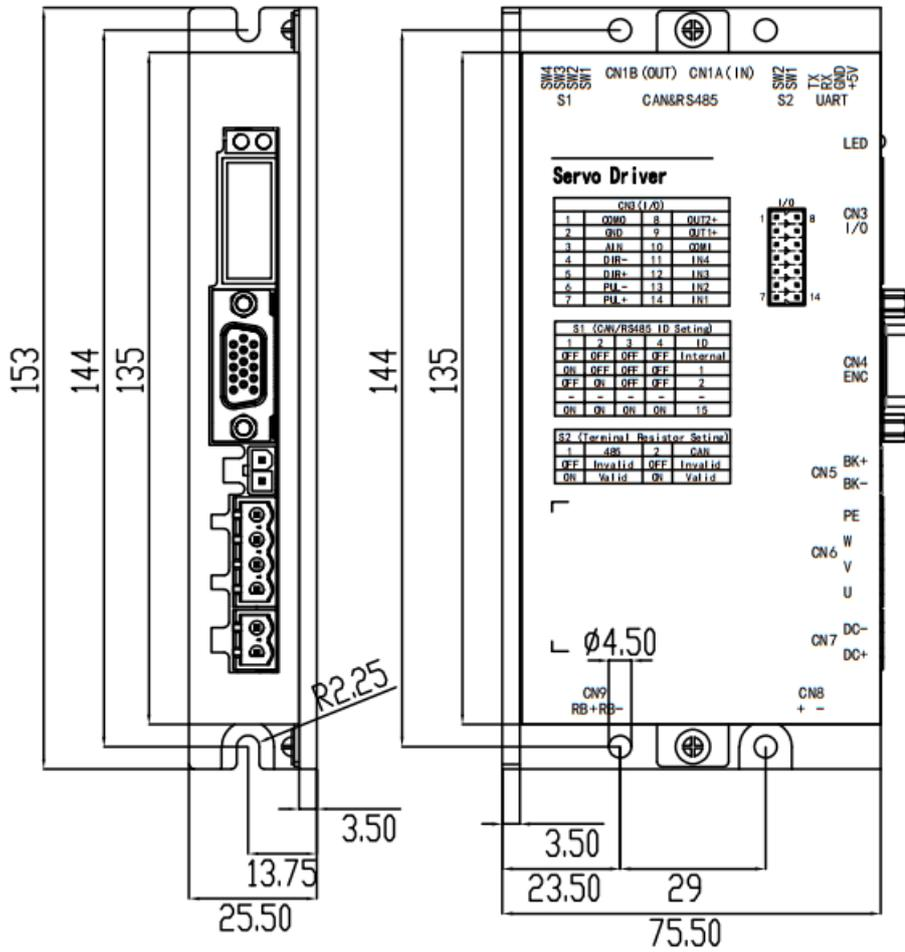
图 3-1 SVD4812RC-AA 驱动器安装尺寸
