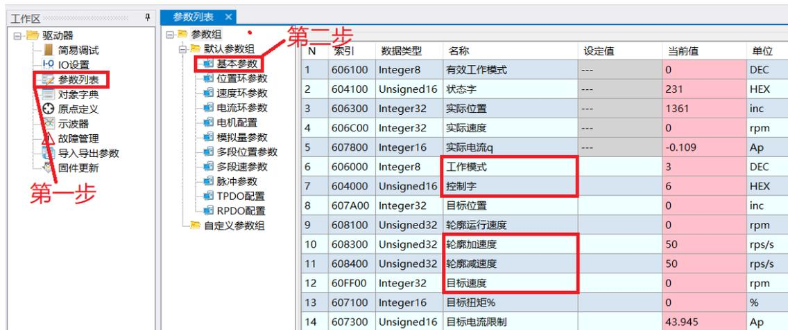
图 6-1 上位机修改速度
