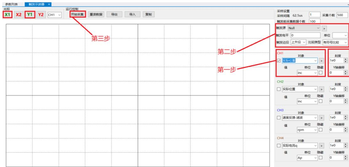
图 5-13 读取实际位置的步骤
