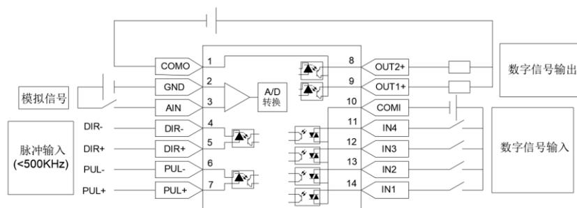
图 4-5 输入输出接口接线图
